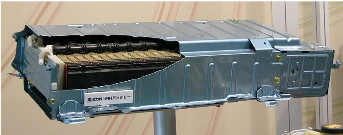
*Figura 2: Batería de la segunda generación del Toyota Prius[37]*
